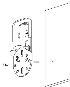
3. Usando a caixa como mapa de instalação, faça as marcações na superfície de acordo com o posicionamento da câmera a ser instalada. Rotacione o suporte de maneira que seja possível fazer as furações e inserir as buchas.
