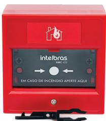
O acionador manual convencional AMC 420 do tipo quebra-vidro, tem como finalidade, quando acionado, o envio de uma sinalização para a central de alarme de incêndio convencional, assim informando o setor ou laço que foi ativado. Ao ser acionado, o AMC 420 comunica a existência de uma emergência para a central de alarme de incêndio por aumento de corrente no laço.
