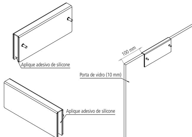
3. Instale o outro suporte na bandeira de vidro, aplique o adesivo de silicone em toda a superfície interna da cortiça e alinhe o suporte da bandeira com base no suporte instalado na porta.
