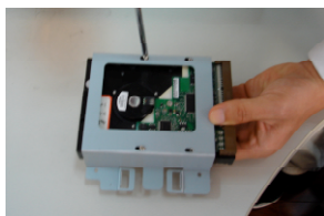
4. Instale o HD. Observe, o HD é colocado de cabeça para baixo. Certifique-se de colocar na posição correta.
