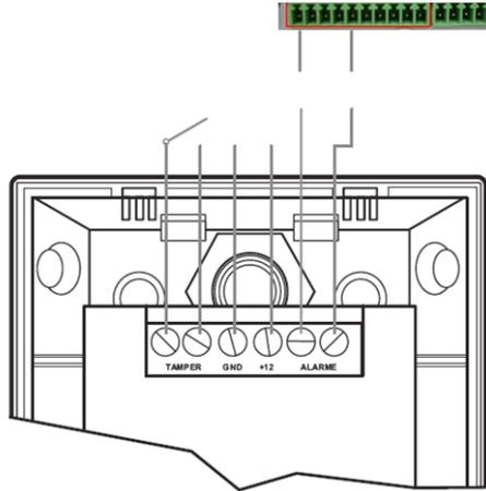
Na configuração da entrada de alarme do DVR, se o tipo de contato for normalmente aberto (NO), o alarme será ativado quando o contato estiver fechado.
