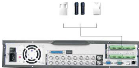
Entrada de alarme
