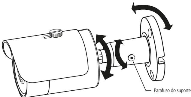
5. Após finalizar a instalação, aperte bem o parafuso do suporte para que a câmera não saia da posição desejada.
