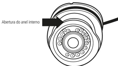
4. Encaixe o anel externo na câmera. Antes de fixá-lo à base da câmera, ajuste o ângulo que se deseja filmar, posicionando a dome e o anel interno até obter a visão desejada. Após isso, gire o anel externo no sentido horário para fixar a câmera a sua base.
