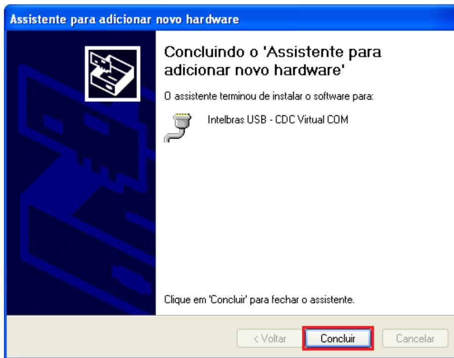
7º - Após a instalação do Driver, é necessário verificar qual porta COM foi gerada no "Gerenciador de Dispositivos". Para abrir o Gerenciador vá até o "Menu Iniciar" clique com o botão direito do mouse no ícone do Meu Computador e navegue até a opção "Propriedades".
