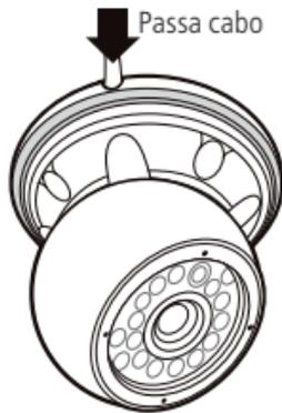
3. Encaixe o anel menor junto à cúpula, tomando o cuidado para que a abertura do anel não tampe a visão da câmera;
