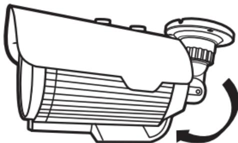
5. Se houver necessidade de ajustar a posição na horizontal, solte o anel de pressão da base do suporte e gire o suporte para a direção desejada. Após ajustar a posição da câmera na horizontal aperte o anel de pressão do suporte;
