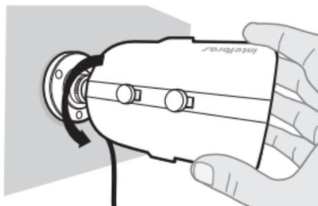
6. Para corrigir a inclinação da imagem, solte o parafuso que prende o suporte ao gabinete e gire-o até que a imagem fique alinhada no monitor. Após ajustar a inclinação da imagem, aperte o parafuso que prende o suporte à câmera.
