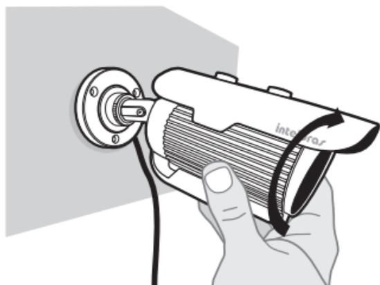
6. Para ajustar a posição horizontal da câmera, solte o parafuso da articulação central do suporte e movimente o gabinete para a direção desejada. Aperte o parafuso da articulação central após realizar esse ajuste;
