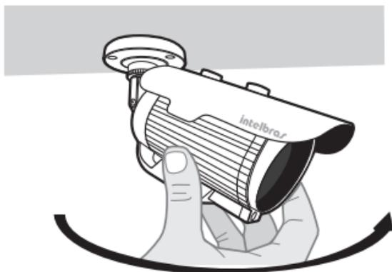
6. Caso haja necessidade de corrigir a inclinação da imagem, solte o parafuso que prende o suporte ao gabinete e gire-o até que a imagem fique alinhada no monitor. Após ajustar a inclinação da imagem, aperte o parafuso que prende o suporte à câmera.
