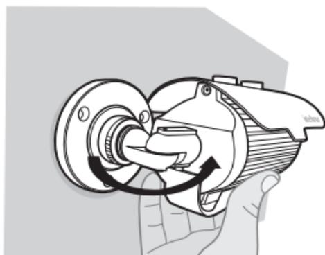
7. Para realizar o ajuste fino no eixo vertical solte o anel da base do suporte novamente e faça as movimentações necessárias. Aperte o anel de pressão do suporte após realizar esse ajuste.
