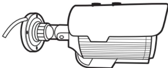
4. Para ajustar o campo de visão da câmera, primeiro solte o parafuso da articulação central do suporte. Após ajustar a posição da câmera na vertical aperte o parafuso da articulação central;
