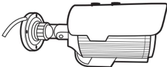
4. Para ajustar a rotação, primeiro solte o anel de pressão da base do suporte e gire a câmera 90° para a direção desejada. Aperte o anel da base do suporte após realizar esse ajuste;
