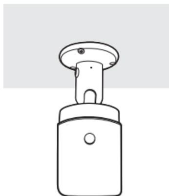
4. Para ajustar o campo de visão da câmera, primeiro solte os parafusos destacados na imagem a seguir, e ajuste a posição vertical da câmera;
