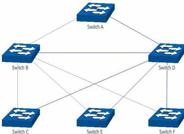
Diagrama da Instância 2 após a convergência STP
