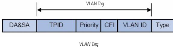
1. TPID: campo de 16 bits, indicando que a estrutura do frame é baseada em tag de VLAN, por padrão este valor é igual a 0x8100.
