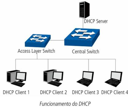
O Servidor DHCP fornece três métodos de atribuição de endereços IPs.
