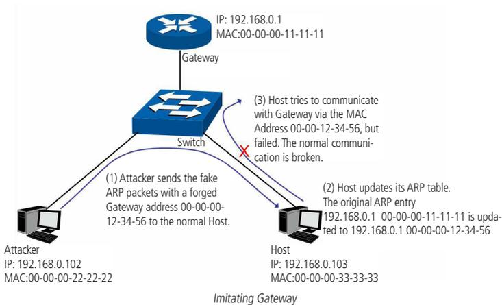
A figura anterior mostra o atacante enviando pacotes ARP falsificados com o endereço MAC do gateway forjado para um determinado computador na rede, em seguida, este computador atualizará sua tabela ARP automaticamente. Quando o computador tentar se comunicar com outro computador localizado em uma rede externa, ele irá enviar pacotes com o endereço MAC de destino errado, resultando na perda da comunicação.
