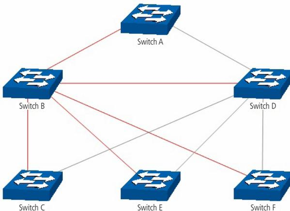
Diagrama da Instância 1 após a convergência STP
