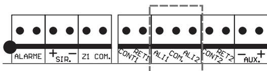
Os módulos de alta tensão devem ser alimentados por este borne. Ligue o terminal COM no negativo do módulo 1 e o terminal ALI 1 no positivo do módulo 1. Se estiver utilizando dois módulos, ligue o terminal COM no negativo do módulo 2 e o terminal ALI 2 no positivo do módulo 2.
