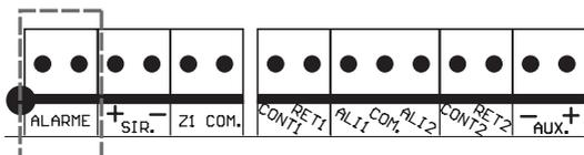
Com o jumper ALAR – SIR na posição ALAR, O borne ALARME permanece liberado para disparar uma central de alarme como se fosse um sensor. Consulte o item *Ativar/desativar sinalização da sirene ao armar/desarmar a central* deste manual.
