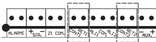
Utilize estes bornes para interligar a central de choque com o módulo de alta tensão. Ligue os terminais RET1 e CONT1 nos terminais CONT e RET do módulo de alta tensão. Se for utilizar mais de um módulo, repita o procedimento para o segundo módulo de alta tensão com os terminais RET2 e CONT2.
