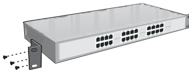
Figura 2 - Fixação dos suportes em "L"
