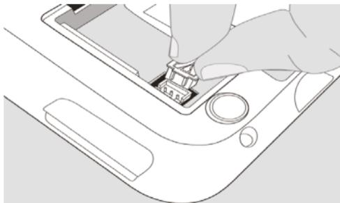
4. Após a instalação, insira a bateria em seu compartimento;
