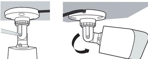
5. Se houver necessidade de ajustar a posição na horizontal, solte o anel de pressão da base do suporte e gire o suporte para a direção desejada. Após ajustar a posição da câmera na horizontal aperte o anel de pressão do suporte;
