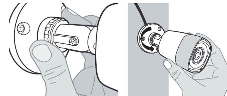
6. Para ajustar a direção da câmera, solte o parafuso da articulação central do suporte e movimente o gabinete para a direção desejada. Aperte o parafuso da articulação central após realizar esse ajuste.
