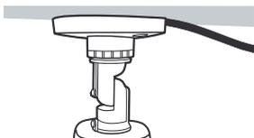
4. Para ajustar o campo de visão da câmera, primeiro solte o parafuso da articulação central do suporte. Após ajustar a posição da câmera na vertical aperte o parafuso da articulação central;
