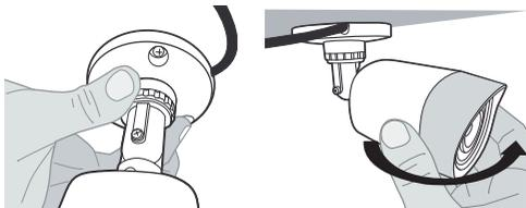
6. Caso haja necessidade de corrigir a inclinação da imagem, solte o parafuso que prende o suporte ao gabinete e gire-o até que a imagem fique alinhada no monitor. Após ajustar a inclinação da imagem, aperte o parafuso que prende o suporte à câmera.
