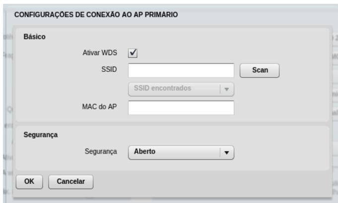
Configuração de conexão ao AP primário. O formulário é dividido em duas seções: 'Básico' e 'Segurança'. Na seção 'Básico', há um campo 'Ativar WDS' com uma caixa de seleção marcada, um campo 'SSID' com um botão 'Scan' e uma lista suspensa 'SSID encontrados'. Abaixo, há um campo 'MAC do AP'. Na seção 'Segurança', há um campo 'Segurança' com o valor 'Aberto' selecionado. No rodapé, há botões 'OK' e 'Cancelar'.
