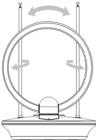
3. Para recepção do sinal UHF e HDTV, mova ou direcione a antena de UHF e HDTV (2) para os lados até obter a melhor recepção.
