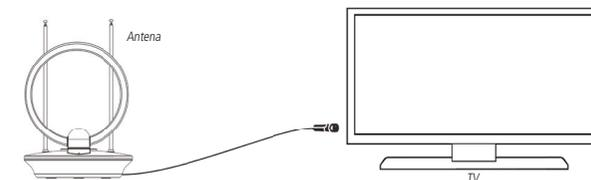
1. Plugue o conector F da antena na entrada de antena ANT da TV;
