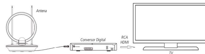
1. Plugue o conector F da antena na entrada de antena ANT do conversor digital, para realizar a ligação do conversor digital no televisor, siga as orientações do manual do fabricante do conversor;
