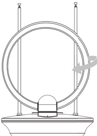
A antena AI 1000 conta com um botão regulador que tem a função de aumentar ou diminuir a potência do sinal recebido pela antena, permitindo minimizar as interferências aumentando a qualidade de imagem da TV.
