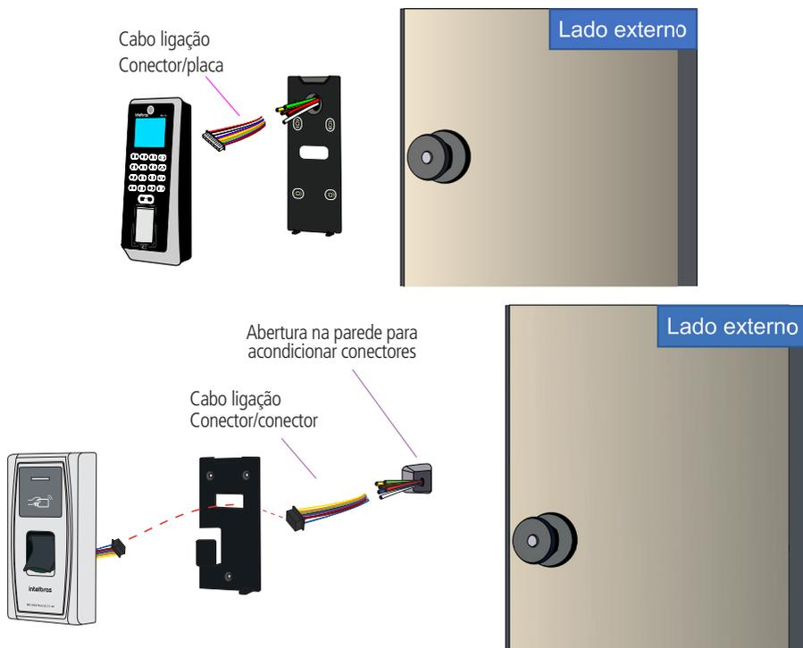
**Nota:** a fiação varia de tamanho em cada leitor. Caso algum leitor tenha emenda por conector (como é o caso dos leitores biométricos LE 311E e LE 311 MF), faça um furo maior na parede para que o conector possa ficar melhor acondicionado, evitando transtorno com o tamanho do cabo e sobras de fios.
