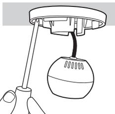
5. Ajuste a cúpula para o ângulo de visão desejado e fixe-a com a tampa, apertando novamente os cinco parafusos com a chave que acompanha o produto.
