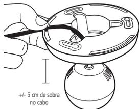
4. Fixe a base na superfície de instalação utilizando três parafusos (acompanham o produto). Mantenha a folga no cabo para facilitar o ajuste da posição da câmera;
