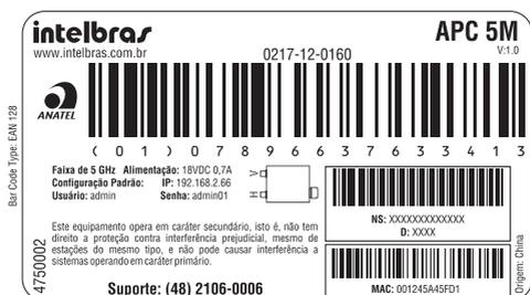
» O conector identificada pela "H" é destinada a polarização horizontal da antena.
