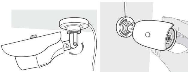
6. Após finalizar a instalação, aperte bem os parafusos e o anel de pressão do suporte para que a câmera não saia da posição desejada.
