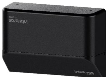
Indicada para portas que abrem para dentro e para fora, a FE 22150 utiliza como princípio de funcionamento a força de tração magnética de 150 kgf. Com estrutura, suportes e tampa de proteção feitos em alumínio injetado e acabamento em pintura a pó, o produto é leve, possui alta resistência à corrosão e baixo magnetismo residual.
