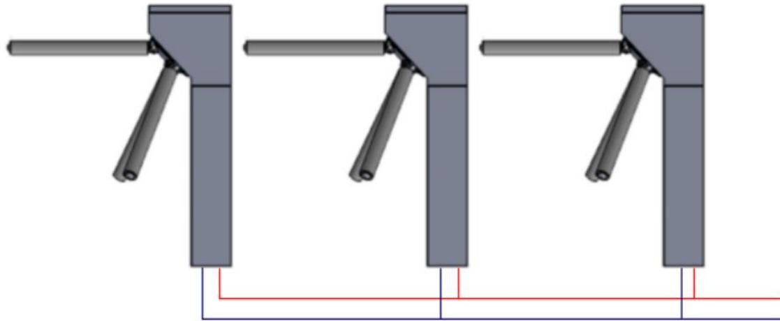
É necessário realizar a passagem dos cabos através das aberturas na parte inferior das catracas, de acordo com a imagem acima.
