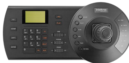
Mesa Controladora Híbrida (Análogica e IP) VTN 2000 G2
