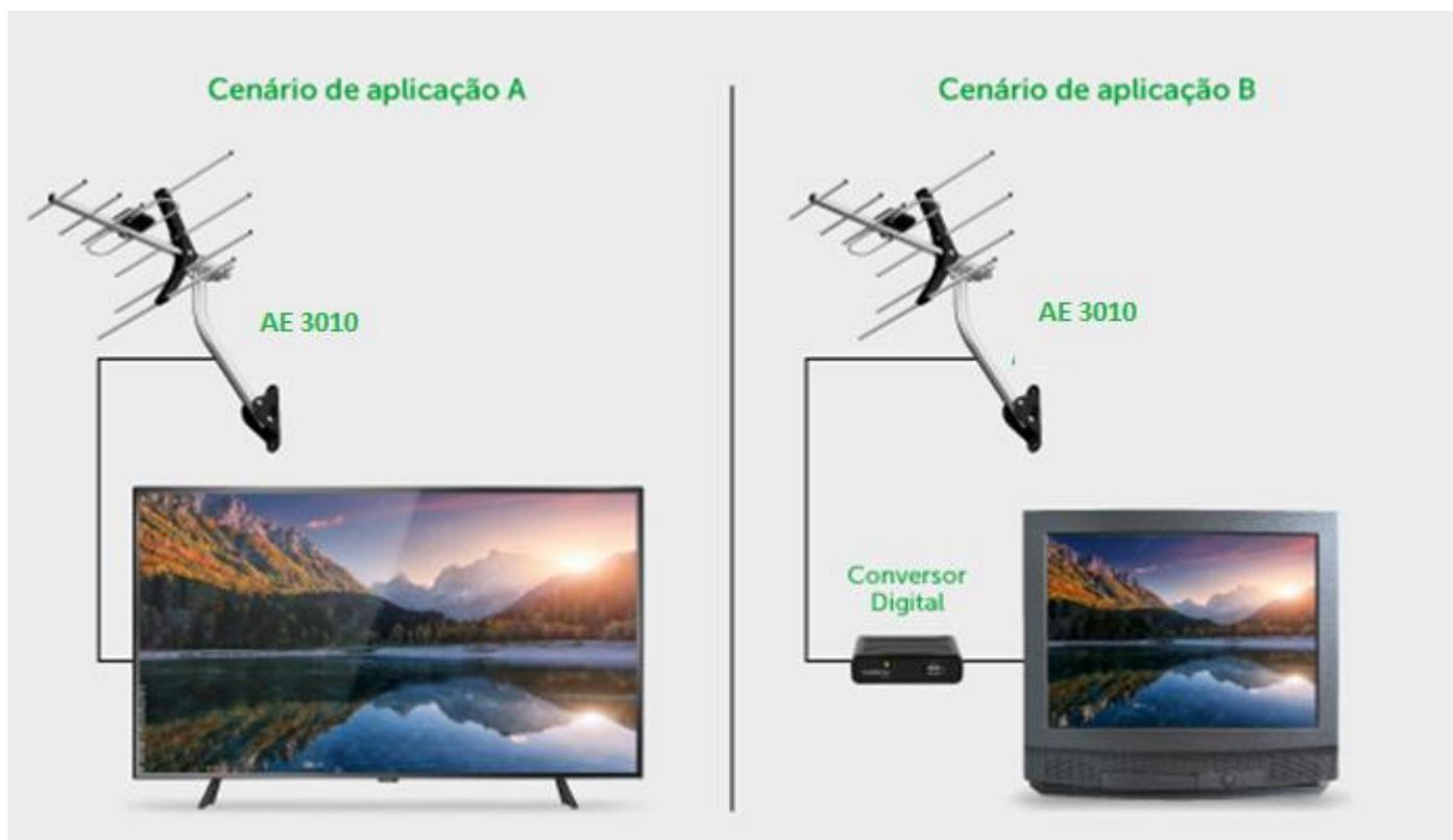
Em TVs com conversores digitais integrado, basta conectar diretamente à TV, conforme cenário A. Para TVs que não possuem conversores digitais integrados, conecte a antena no conversor, conforme cenário B.
