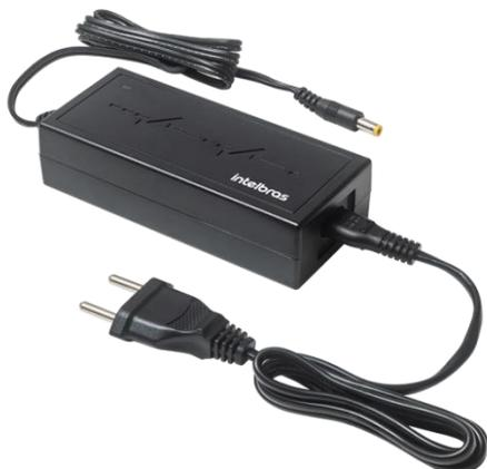
A fonte EF 1205 é projetada para dispositivos 12 V com consumo de até 5A. Ela possui proteção contra curto-circuito e sobrecarga, prevenindo danos decorrentes de avarias elétricas, e contra sobretensão, para evitar ou minimizar problemas causados por descargas atmosféricas ou manobras da rede de distribuição elétrica. Além disso, possui filtro contra ruídos e interferências na imagem.
