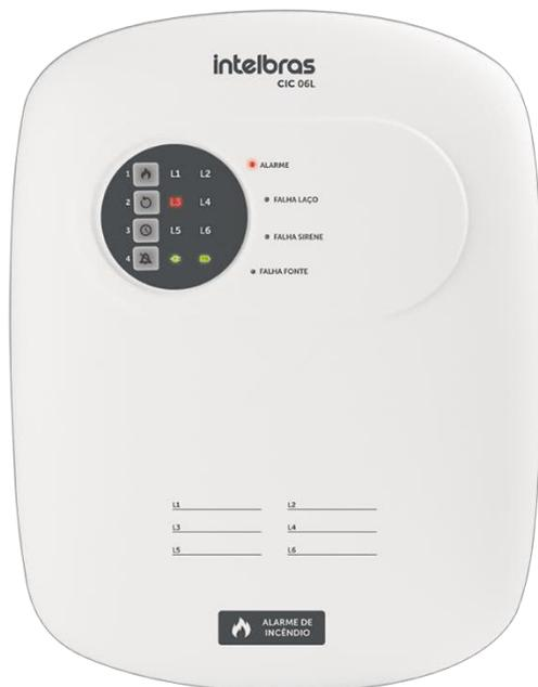
El panel de alarma de incendio CIC06L, tipo convencional, es ideal para ambientes chicos. Tiene un excelente costo-beneficio, comporta hasta 6 enlaces y 20 dispositivos por enlace. Fácil operación, le permite al usuario configurarlo vía teclado y monitorearlo de manera ágil a través del panel con LEDs. Tiene una salida de sirena y dos de contacto seco, para señalar fallas y alarma.
