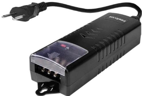
A EF 1203+ é uma fonte multissaiada projetada para dispositivos 12 V com consumo de até 3 A. Ela possui proteção contra curto-circuito, sobrecarga e sobretensão, e também filtro contra ruídos e interferências na imagem. Construída em plástico, possui saída com bornes para conectar mais de um dispositivo diretamente na fonte e entrada através de plugue de tomada, com engate para fixação em parede.
