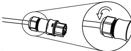
8. Após a conectorização conecte o plugue CA no inversor.
