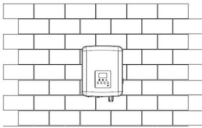
3. Para segurança, trave o inversor no suporte de parede usando o parafuso de fixação.
