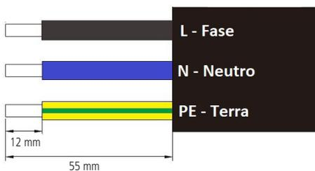
2. Separe o conector CA em três partes;
