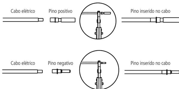
4. Transpasse a porca pelo pino inserido no cabo e deixe-o em espera, insira o pino do cabo no conector até o final ou até quando ouvir um *clique*, depois rosqueie a porca no conector para travar o cabo (a porca não precisa chegar ao final, aperte apenas o suficiente para prender o cabo). Após esse procedimento os conectores estarão prontos para serem utilizados;
