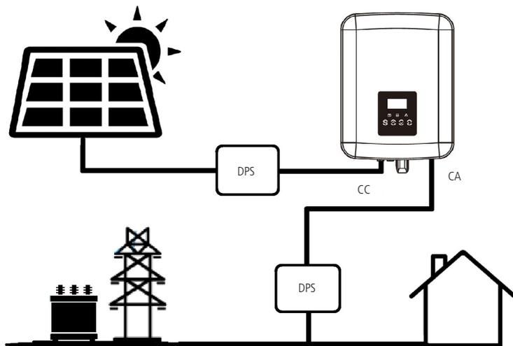
As descargas atmosféricas são as principais causas de danos ao inversor na maior parte das instalações. Para proteger o inversor contra essas descargas atmosféricas é necessário a instalação de DPS na entrada do arranjo fotovoltaico CC e na saída do inversor para rede de energia CA da concessionária. Para realizar a instalação recomendamos procurar orientação com especialistas em sistemas de aterramento e proteção contra descargas atmosféricas e que siga as normas NBR 15749/ NBR 5419/NBR 16690.
