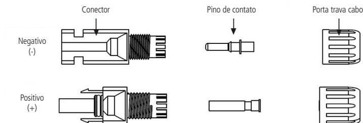
1. Para ligação do arranjo fotovoltaico ao inversor utilize cabo isolado de 4 mm para uso em área externa;
