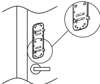
6. Parafuse a chapa de fixação, no lado interno da porta. Para fixar a chapa, utilize 4 parafusos A (M4 x 20);
