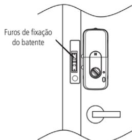
15. Faça as furações e parafuse o batente ou falsa-testa no local marcado. Para fixar, utilize quatro parafusos B (M4 x 25);
