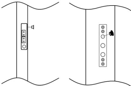
17. Remova o adesivo presente na chapa de acabamento e coloque a chapa no batente. Desta forma os furos e as linguetas ficarão ocultos, conforme imagem a seguir:
