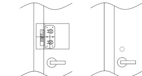
**Importante:** apenas para abertura para dentro - antes de montar o produto, verifique se os acabamentos e/ou vista/guarnição da porta prejudicam a instalação. Pegue a unidade interna e projete a lingueta utilizando a manopla. Coloque-a sobre o local de instalação, juntamente com o batente, conforme a imagem a seguir:
