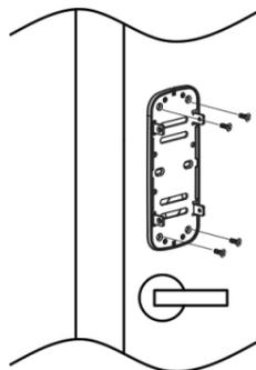
7. Passe o cabo da unidade externa pela chapa de fixação;
