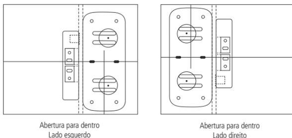
2. Utilizando o gabarito de instalação, marque o furo de 32 mm inferior (ignore o furo superior). Faça o furo de 32 mm utilizando uma serra-copo;
