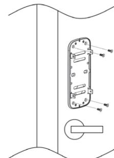
6. Passe o cabo da unidade externa pela chapa de fixação. Para uma melhor aderência, utilize a fita dupla-face;
