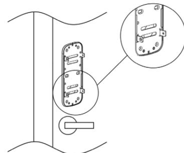
4. Parafuse a chapa de fixação no lado interno da porta;
