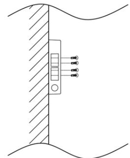
14. Gire a manopla para projetar e retraindo a lingueta e verificar o funcionamento entre as linguetas e o batente;
