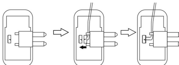
**Obs.:** para facilitar, remova a parte plástica sobre a placa eletrônica e, após encaixar o cabo, recoloca-a novamente.
