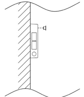
16. Remova o adesivo presente na chapa de acabamento e coloque a chapa no batente. Dessa forma os furos e a tranca ficarão ocultos, conforme imagem a seguir:
