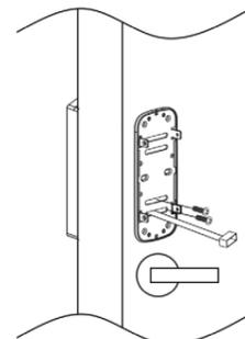
**Importante:** remova o parafuso I ao instalar em portas com espessura inferior a 35 mm ou ao utilizar calços.
