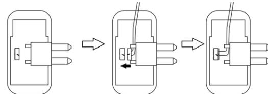
**Obs.:** para facilitar, remova a parte plástica sobre a placa eletrônica e após encaixar o cabo, recoloque-a novamente.
