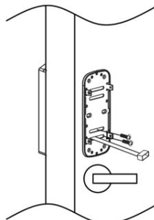
9. Encaixe o conector da unidade externa na unidade interna. Há apenas uma posição de encaixe indicada por uma marcação em ambos os conectores;
