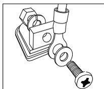
**Atenção:** verifique a polaridade dos conectores do nobreak e da bateria. Cabo vermelho deve ser conectado ao terminal positivo (+) da bateria, e o preto ao negativo (-).
