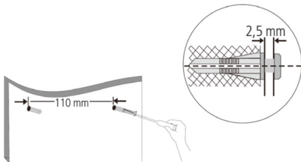
5. Manuseie o switch até a parede a fim de encaixar os dois orifícios presentes na parte inferior do dispositivo nos parafusos que foram fixados.
