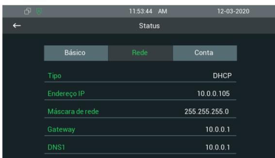
**Importante:** caso não utilize uma rede com servidor DHCP para que o IP seja atribuído ao TVIP 3000 UN é possível configurar um IP estático navegando em *Configurações/Avançar/Rede/DHCP*.
