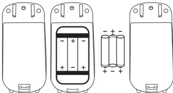
5. Instale as baterias recarregáveis de 1,2 Vdc de 600 mAh.
