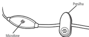
**Obs.:** sempre que utilizar o fone de ouvido,<sup>1</sup> tenha certeza de que o microfone esteja direcionado à boca. Desta forma o áudio transmitido terá uma melhor qualidade. Utilize a presilha para facilitar o bom posicionamento do microfone.
