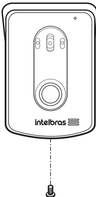
**Atenção:** » Não esqueça de inserir todos os cabos da instalação pela passagem de cabos da tampa traseira do produto que será parafusada no local da instalação..
