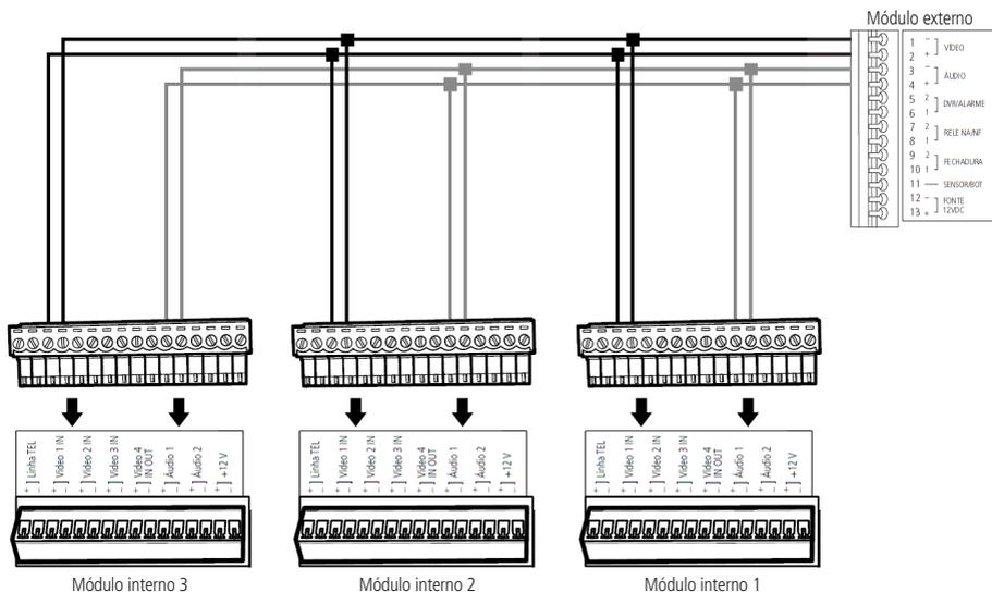
Conexão com 3 módulos internos e 1 módulo externo
