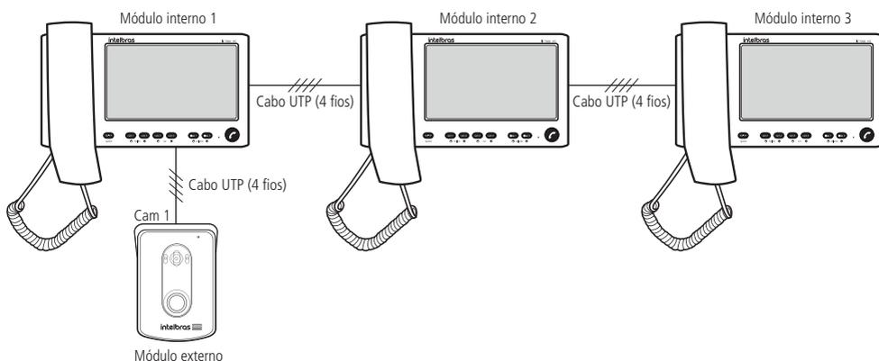
*Instalação com 3 módulos internos e 1 módulo externo*
