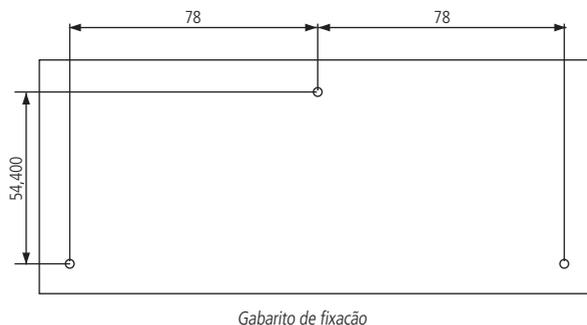
2. Fure a parede com uma broca apropriada para concreto. As buchas de parafuso que acompanham o produto possuem 6 mm de diâmetro;
