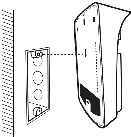
3. Posicione o produto de forma que a posição central de fixação encaixe no parafuso. Em seguida desloque o módulo externo para baixo até encaixar e fixe o inferior para finalizar a instalação;
