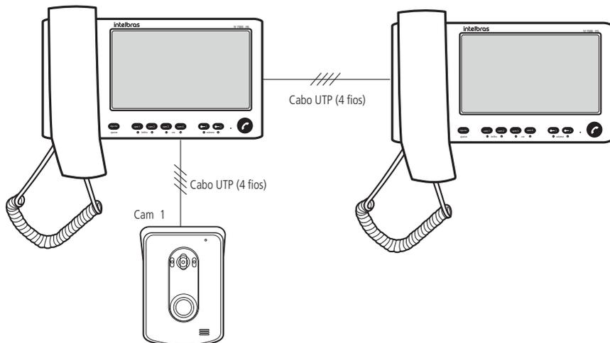
Instalação com 2 módulos internos e 1 módulo externo
