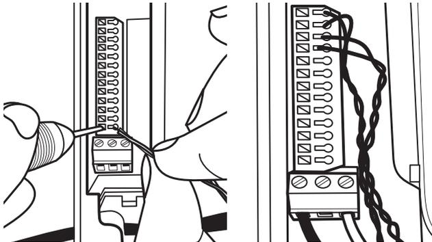
5. Certifique-se de que todos os cabos utilizados na instalação estejam devidamente presos ao conector e verifique se a polaridade dos cabos esteja correta.
