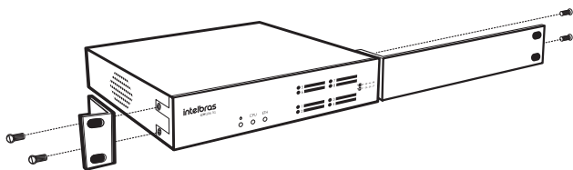
Instalación con un gateway
