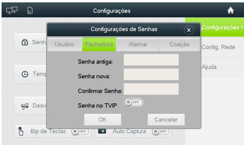
Existem 6 diferentes tipos de senhas que podem ser usadas no TVIP 500/1000/2000 HF. Apenas 4 dessas senhas poderão ser alteradas pelo usuário no próprio TVIP 500/1000/2000 HF. São elas: *Usuário*, *Fechadura*, *Alarme* e *Coação*.
