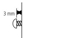
3. Para a instalação na vertical, escolha o local e faça apenas um furo para fixar o produto. Siga o passo 2 para a fixação do produto.
