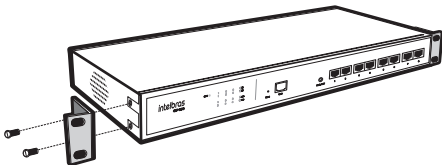
Instalación de los soportes en la central
