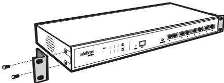
Instalação dos suportes na central
