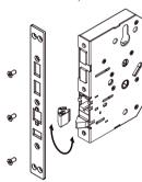
3. Utilize o gabarito para fazer as marcações dos furos de 32 e 68 mm, as marcações do furo do mecanismo e faça também as marcações do acabamento da forra. Recomendamos instalar a fechadura a uma altura mínima de 90 cm do piso:
