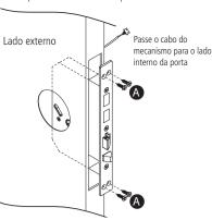
**Importante**: ao encaixar o mecanismo na porta, certifique-se que o cabo não sofrerá nenhum tipo de dano. Não faça a instalação caso notar qualquer dano no cabo do mecanismo! Nesta situação, procure uma assistência técnica autorizada.
