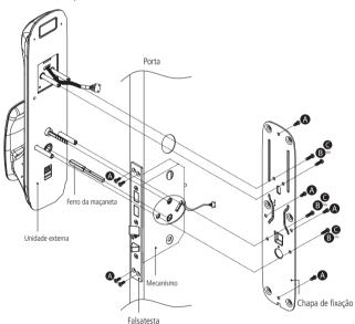
Encaixe os conectores da unidade externa e do mecanismo tranca nos respectivos conectores da unidade interna;
