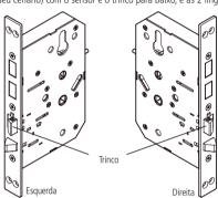
2. Caso seja necessário inverter a posição do trinco, remova os parafusos e a falsatesta e gire o trinco de acordo com seu cenário. Por fim, insira novamente a falsatesta e os parafusos.
