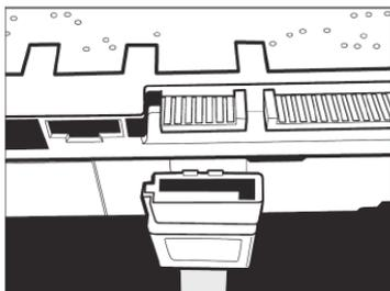
8. Conecte uma das pontas do cabo de força ao HD;
